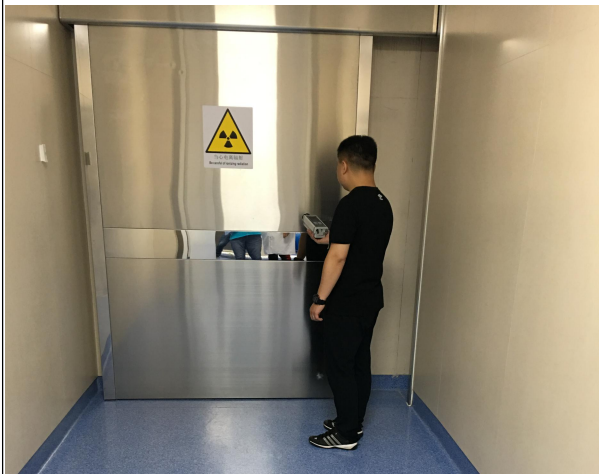
回旋加速器机房防护门外检测
